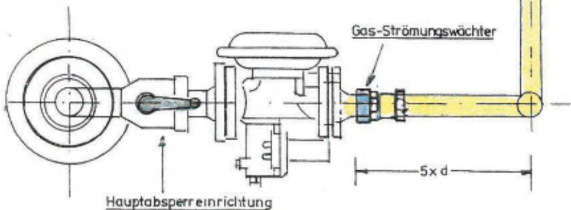
INSTALLATIONS-SCHEMA: Mehrfach Gaszähler mit Strömungswächter
